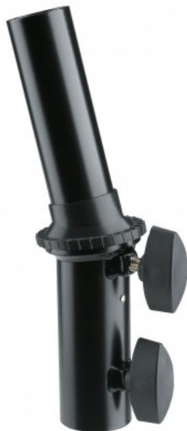
Per supporti per altoparlanti con tubo di diametro 35 mm. Angolo regolabile a 15 °. Fissato con vite di bloccaggio. - Maximum central load capacity: 25 kg. Peso: 0.7 kg, H: 230 mm.
