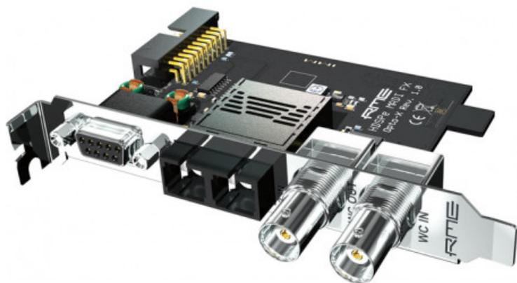
OPTO-X è una scheda di espansione optional per l'interfaccia HDSPe MADI FX. Esattamente come la scheda di espansione fornita in dotazione, OPTO-X ha un I/O Word Clock e un connettore D-Sub per gli I/O MIDI e AES/EBU. OPTO-X consente di sostituire le connessioni MADI coassiali della HDSPe MADI FX con connessioni ottiche. Con l'OPTO-X la HDSPe MADI FX diventa un'interfaccia MADI con 3 I/O MADI ottici.
