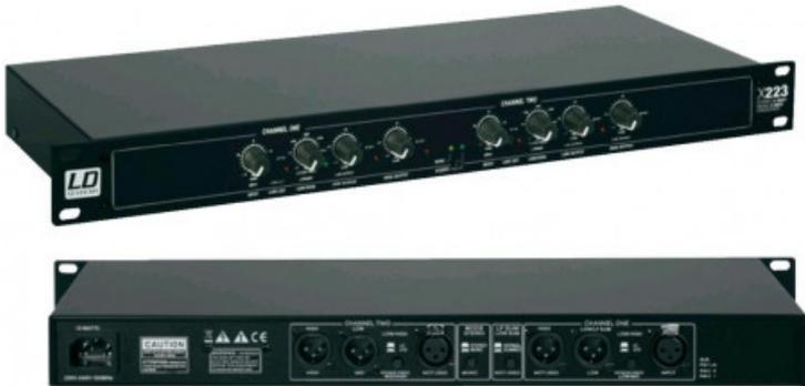
LD X223 è un crossover in formato rack standard (19"/ 1 U) che permette una suddivisione del segnale su 2 vie (stereo) o 3 vie (mono). Questo crossover si contraddistingue per la robustezza del corpo, l'elevata qualità, la stabilità degli elementi di controllo e un alimentatore integrato, caratteristiche non certo scontate nella sua classe di prezzo.
