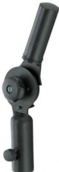
Adattatore per stativi casse, con attacco femmina  $\varnothing 36$  mm e attacco maschio H=120 mm da  $\varnothing 35$  mm, per l'applicazione della cassa, con un'inclinazione progressiva di  $4^\circ$  mediante un sistema di snodo ad ingranaggi con relativo arresto di sicurezza. Il serraggio sullo stativo è garantito da una manopola M8.
